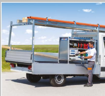
Optionale Lastenauflage für HR-200 zum Langguttransport über Bordwand
