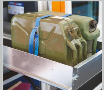
Auszuglade\* für den sicheren Transport von Gefahrgut i. R. d. Handwerkerregelung
