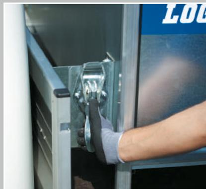
Schnellmontage-System\* zur einfachen Montage und Demontage der Box auf der Pritsche
