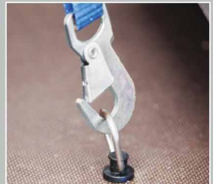
Frei platzierbarer Zurrpunkt, falls Original-Zurrpunkte des Fahrzeugs verdeckt werden
