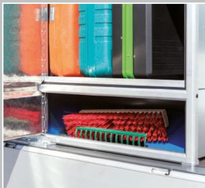
Großer Stauraum\* mit Drehriegelverschluss für langstieliges Werkzeug, Zugriff und Beladung von beiden Fahrzeugseiten
