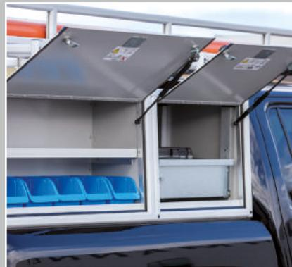
Seitliche Klappen mit Gasfeder für PickUp Box, Seitenbox\* HardTop mit Zwischenboden\*
