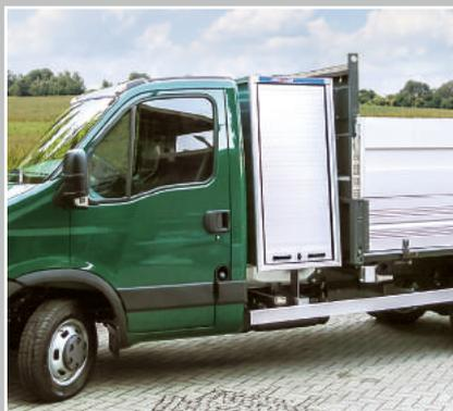
Montage auch zwischen Fahrerkabine und Kipperaufbau möglich
