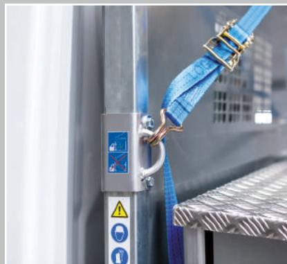
Frei positionierbare Zurrkonsole\* zur kraftschlüssigen Ladungssicherung
