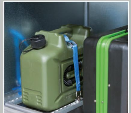
Zurrset\* zum sicheren Transport von Gefahrgut im Rahmen der Handwerkerregelung
