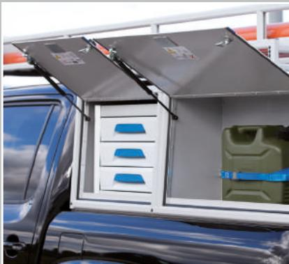
Ladencontainer\* für Kleinmaterial, Seitenbox\* HardTop mit Alu-Zurrschiene\*
