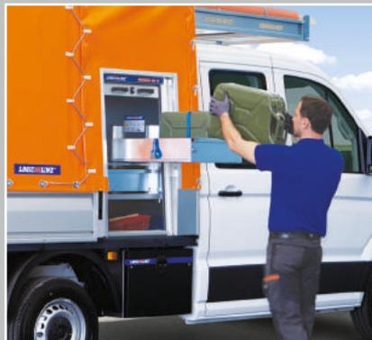
Einfaches Be- und Entladen von Kanistern durch Auszuglade für Gefahrguttransport
