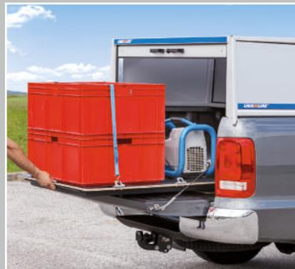
Einfache Be- und Entladung von schweren Lasten bis 200 kg mit Schwerlastauszug\*
